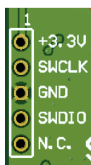
Рисунок 2. – Разъем SWD на плате контроллера процессорного микроконтроллера
